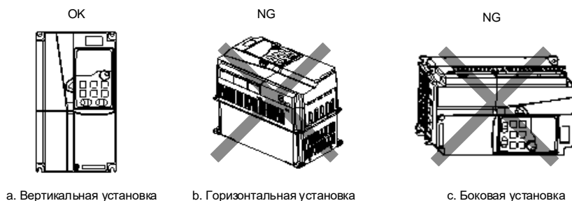
Рисунок 4-1 Направление монтажа частотно-регулируемого привода (ЧРП)
