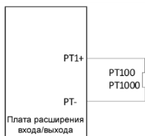
Рисунок 5-25 PT100/PT1000, измеряющий температуру через плату расширения
