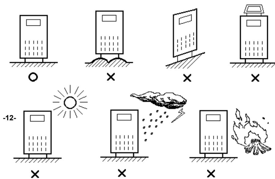
Рис. 3-1 Предупреждения при установке ИБП
