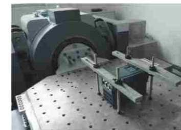
Система вибрационных испытаний электромагнитным возбудителем
