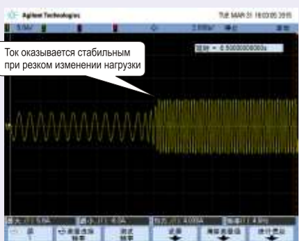
Форма тока при внезапной нагрузке в режиме векторного управления с полной нагрузкой на частоте 0,5 Гц.
